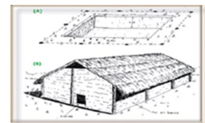
Figure 5: Fosse et hangar surmontant une fosse de conservation de l'igname
